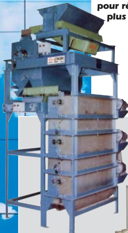
Rollap 80 à bande à 3 niveaux avec prétrieur basse intensité.
